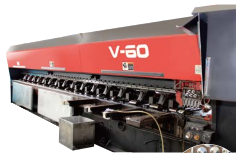
アマダ V カット加工機 V6012 (加工寸法 1200mm×6000mm) 5本バイトでワンパス加工
