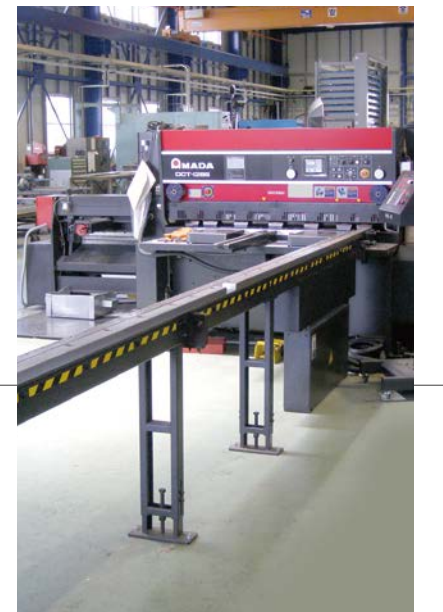
アマダ メカニカルシャーリング DCT1265 (加工寸法 1270mm) アマダ NC フロントゲージ AMADAN-FG.IV (ゲージ寸法 6000mm)
