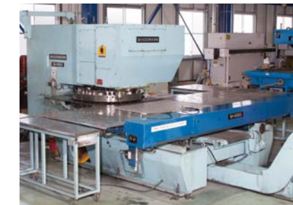
村田機械タレットパンチ W4560 (加工寸法 5'×10')
