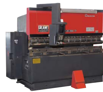
アマダ プレスブレーキ FBD-1025F (加工能力 100t 加工寸法 2505mm)
