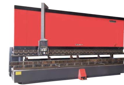
アマダ プレスブレーキ FBD-4006 (加工能力 400t 加工寸法 6000mm)
