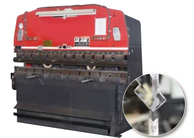
アマダ プレスブレーキ RG-100S (加工能力 100t 加工寸法 2505mm)
